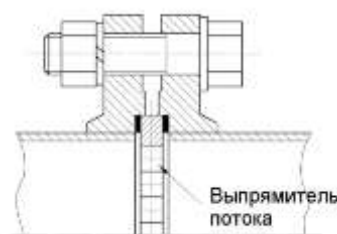
Рисунок 2.8 - Схема монтажа выпрямителя потока
